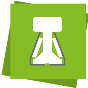
Schienenstegabschirmer und -dämpfer bringen **bis zu 3 dB(A)** und werden direkt am Gleis montiert
