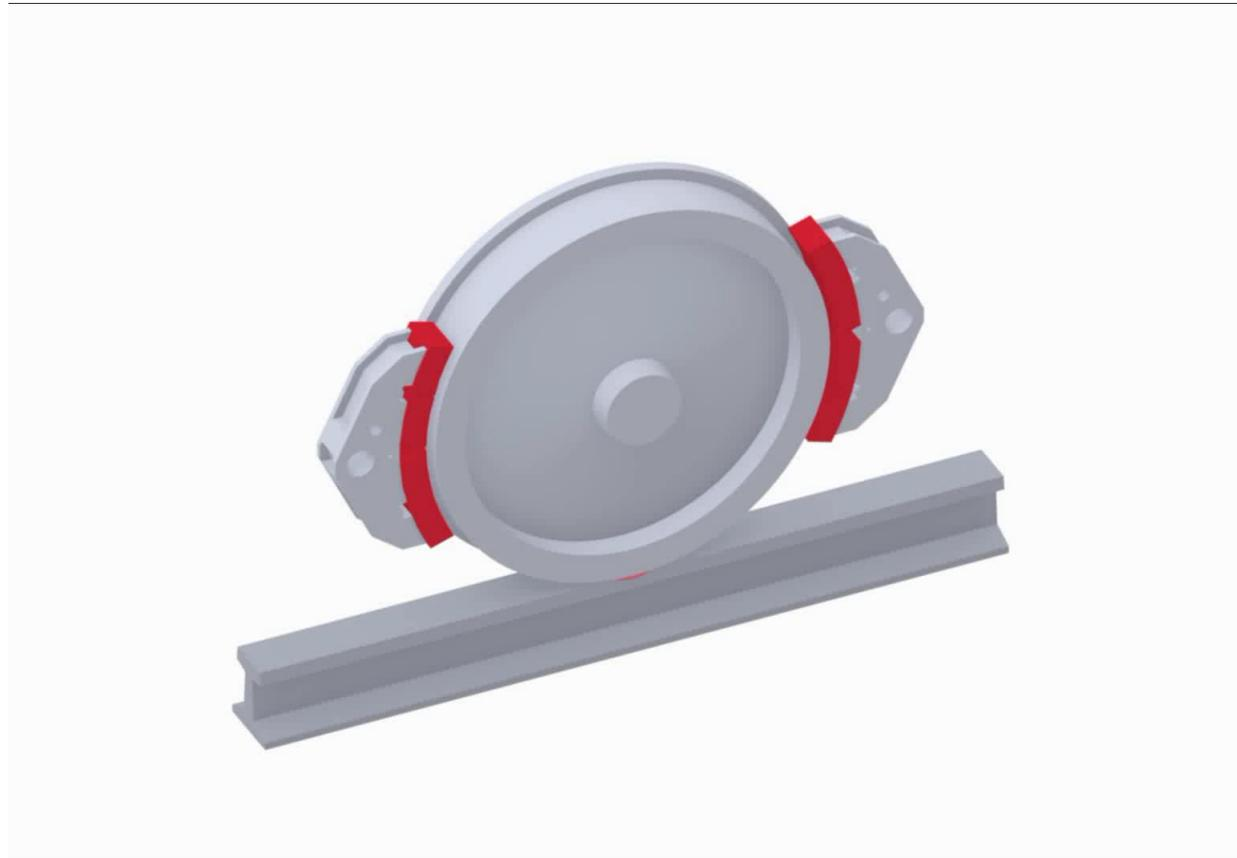
Güterwagen rollen in der **Vorbeifahrt** um bis zu **10 dB(A) leiser**, wenn sie mit **modernen Bremssohlen** aus Verbundstoffen ausgerüstet sind
